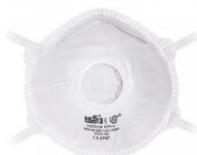
Facciale filtrante per polveri poco tossiche e nebbie e fumi a base acquosa. Il livello di protezione è pari a 4,5 volte il TLV (valore limite di soglia pericolosità). La mascherina è dotata di valvola di espirazione.
