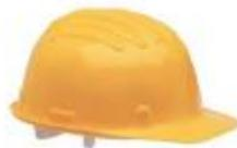
Elmetto in polietilene HD, con 4 punti di ancoraggio e bardatura interna in tessuto smontabile, isolamento dielettrico 440 Volt, con spugna parasudore. Colori assortiti.
